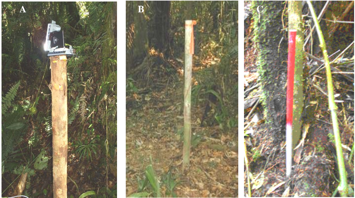
Figura 3. A) Ubicación de la brújula en una estaca con el fin de seguir un rumbo correcto, B) Jalón principal y C) Tubo de PVC (© Proyecto Madidi LPB–MO).
