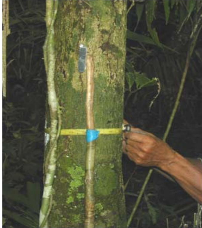
Figura 9. Medición del árbol a 1,30 cm y ubicación de la placa de aluminio 20 cm más arriba.
